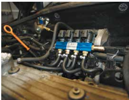
Рис.3 Крепление форсунок в отсеке двигателя
