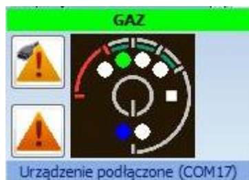
Rys. 3.3 Wirtualny panel z paskiem stanu oraz trójkątem informującym o zarejestrowaniu błędu przez sterownik NEVO oraz OBD.
